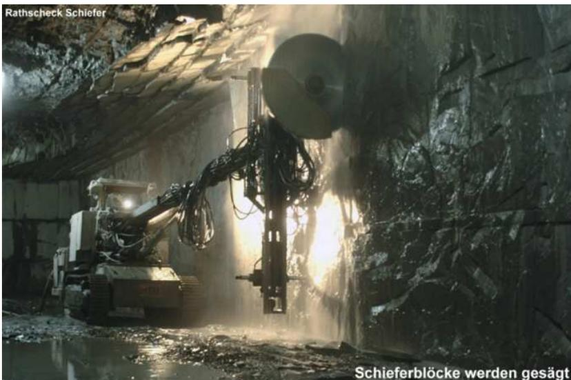
*besetzten kreisförmigen Sägeblätter von mehr als einem Meter Durchmesser konnten durch eine Schwenkvorrichtung in jede beliebige Position eingesetzt werden. So entstand ein gleichförmiges Muster aus Rechtecken.*
