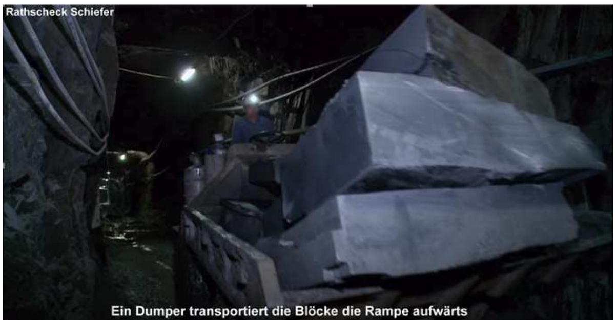
Von dort aus ging es über die Rampe abwärts. Rampe ist ein geniales Wort für einen Tunnel, der sich serpentinartig abwärts windet. 15 Prozent Gefälle, beziehungsweise 15 Prozent Steigung, denn es gab nur diesen Weg zurück. Die Installation von Rampen ermöglichte im modernen Untertage-Schieferbergbau die Mechanisierung, den Einsatz von Baumaschinen und automobiler Technik, die sich innerhalb der 4 mal 4 Meter messenden Tunnelanlage
